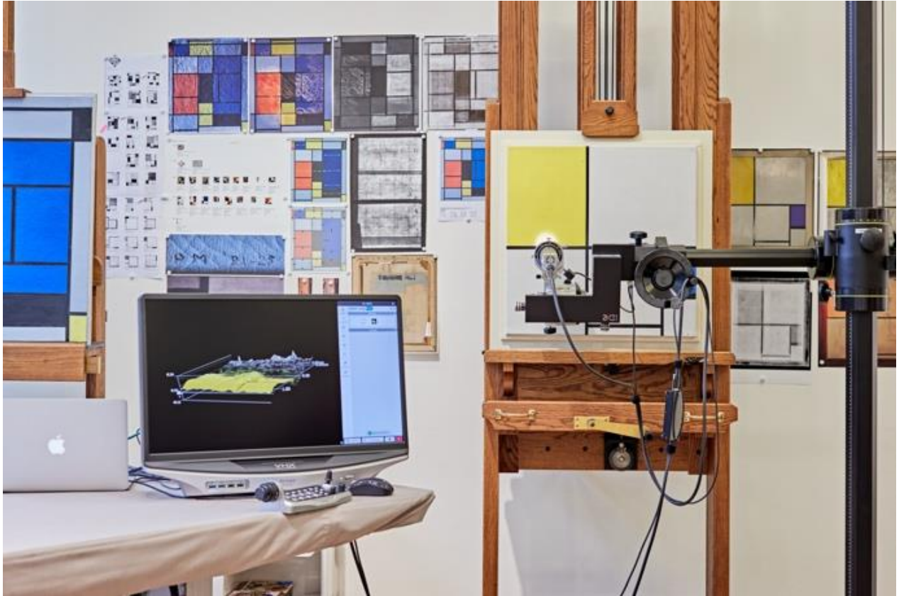
Abb. 3 Kompletter Aufbau mit Keyence VHX-7000, IDC Multiachsenkopf und FOBA-Stativ Piet Mondrian, Composition with yellow and blue, 1932, Fondation Beyeler, Riehen/Basel, Sammlung Beyeler
